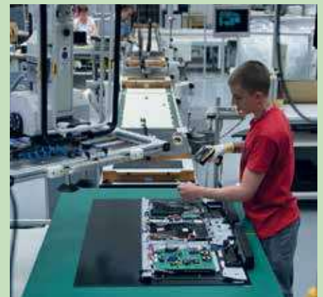
Handarbeit: Die OLED-Fernseher werden am Stammsitz in Kronach weiterhin mit hohem Aufwand und einer umfassenden Endkontrolle hergestellt.
