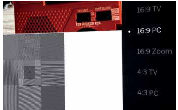
Wird das Bildformat von 16:9 TV auf 16:9 PC umgestellt, werden alle UHD-Pixel vollständig abgebildet.
